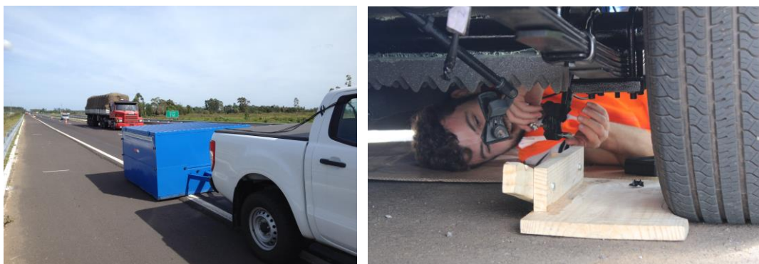
Figura 2: Trailer-CPX e instalação dos microfones
