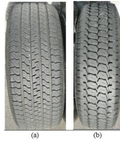
Figura 1: Pneus de referência do trailer CPX: (a) ASTM SRTT e (b) Avon AV4 (Bühlmann et al. 2013).
