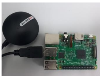
Figura 3: Sniffer construído: Raspberry PI 3B, com sensor GPS e placa Wi-Fi.
