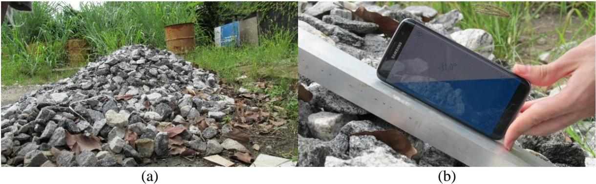
**Figura 2:** Pilha do material (a) e a medição do ângulo de repouso em  $31^\circ$  (b)
