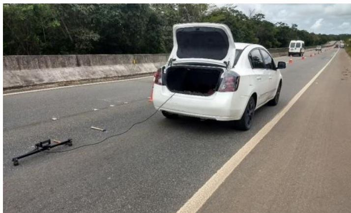
Figura 2: Aplicação do método SASW no TMA-DNIT.
