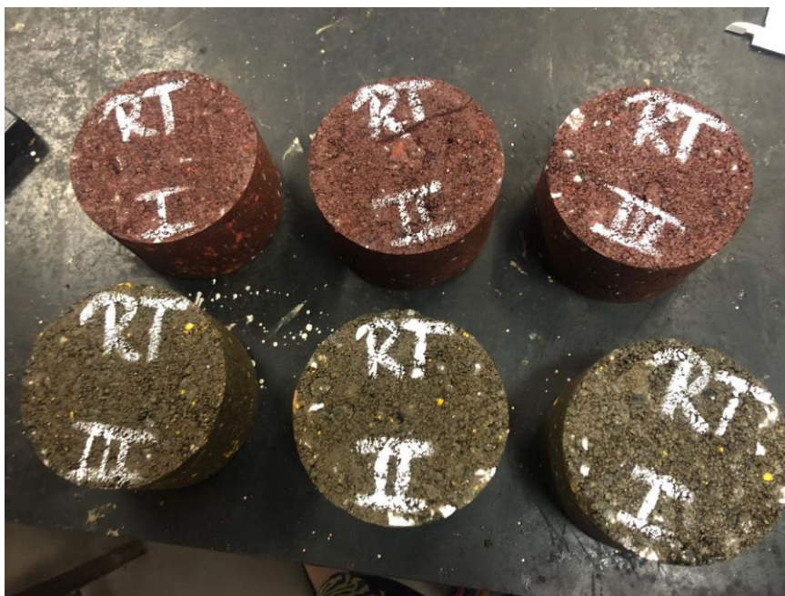
Figura 6: Corpos de prova com a adição do óxido de ferro, nas cores vermelho e amarelo
