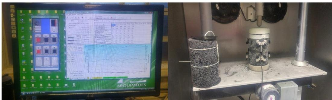
**Figura 2:** Ensaio de Módulo Complexo
