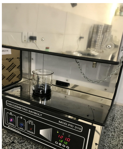
Figura 5: Ensaio de viscosidade utilizando o viscosímetro Saybolt Furol; conduzido na Faculdade Brasileira - Multivix.
