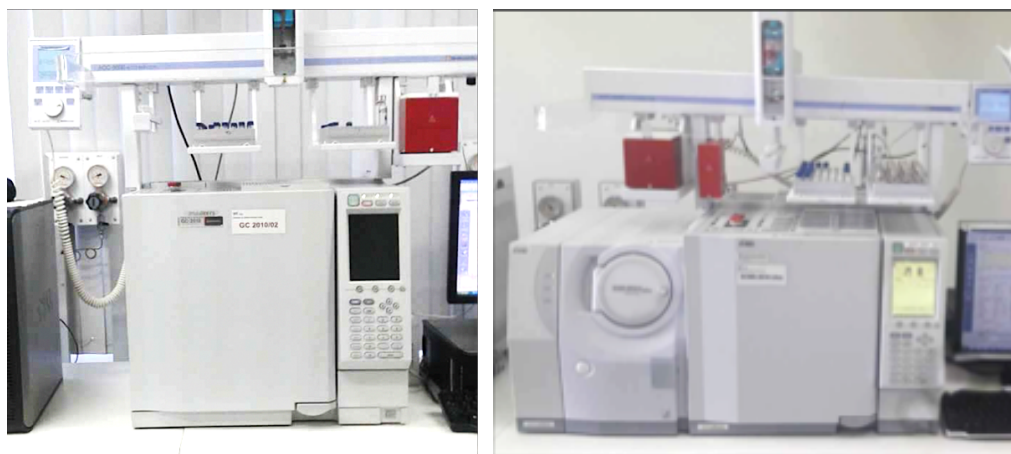
Figura 3: Equipamentos utilizados para as análises cromatográficas (conduzido no IPT - Instituto de Pesquisas Tecnológicas).
