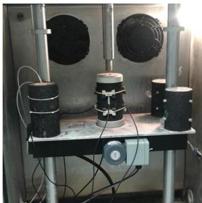
**Figura 2:** Realização do ensaio de Módulo dinâmico na prensa UTM-25 no LMCC.
