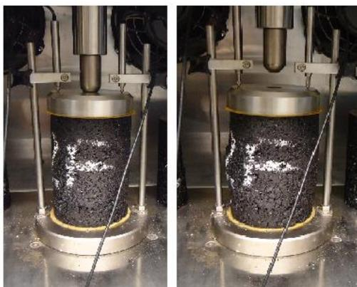
**Figura 3:** Realização do ensaio *Flow Number* na prensa UTM-25.
