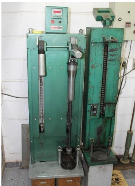
**Figura 4:** Equipamento de compactação.
