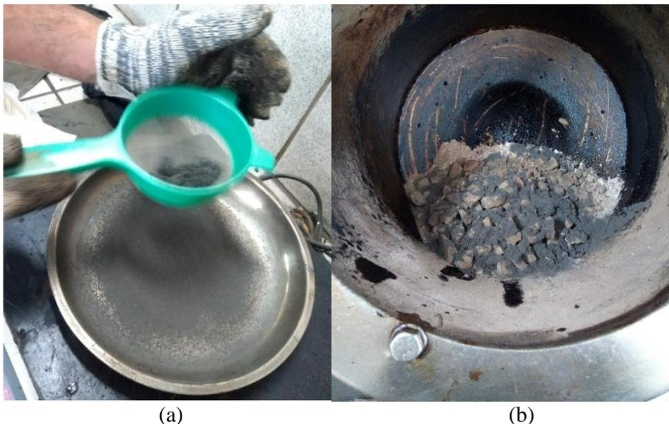
**Figura 3:** (a) limalha sendo peneirada; (b) agregado pré-misturado na cuba
