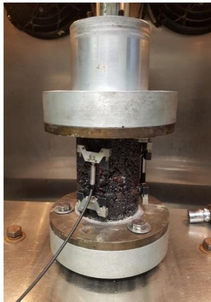
Figura 2: Realização do ensaio de fadiga tração-compressão uniaxial
