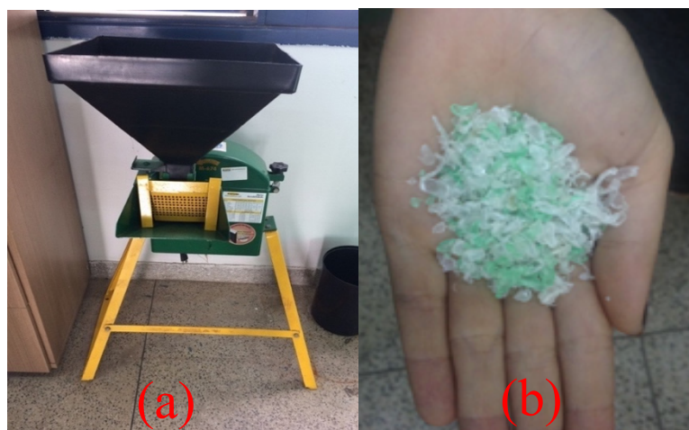
Figuras 3: (a) Triturador de lâminas e (b) PET triturado
