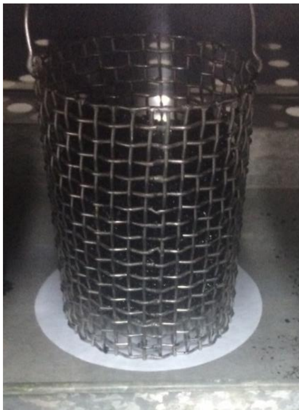
Figura 3: Cesto contendo a mistura para o ensaio de escorrimento
