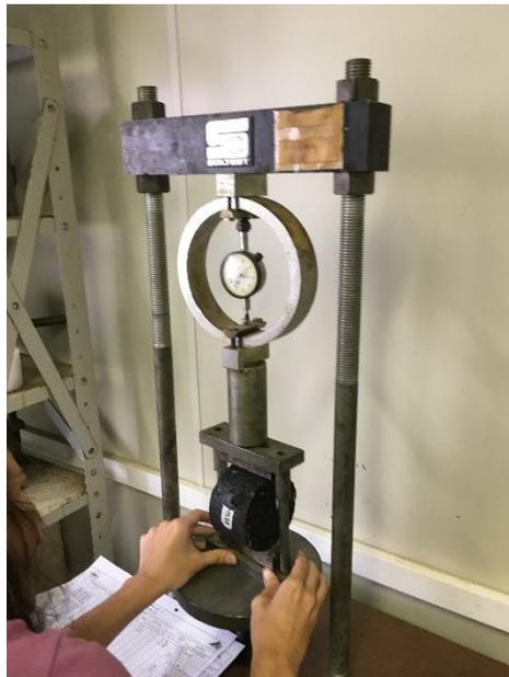
**Figura 6:** Ruptura do CP durante os ensaios de RT por compressão diametral
