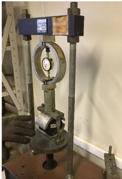
**Figura 4:** CP's submetidos ao ensaio de estabilidade e fluência Marshall
