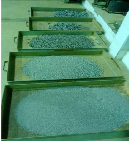
**Figura 1:** Granulometria: Separação dos agregados por peneira
