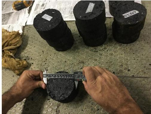
**Figura 3:** Medição dos corpos de prova com a utilização de um paquímetro eletrônico
