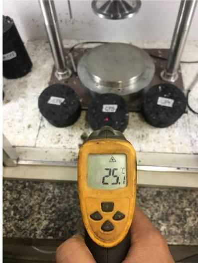
**Figura 5:** CP's antes do ensaio de RT por compressão diametral
