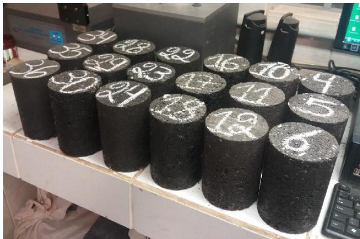
**Figura 5:** Corpos de prova após ensaio uniaxial de carga repetida sem deformação visual
