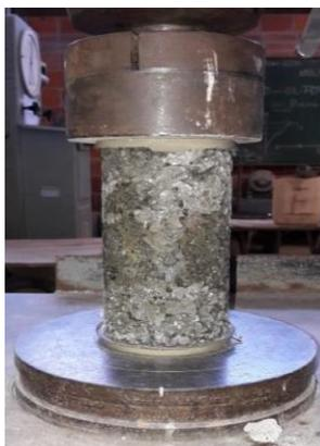
**Figura 3:** Ensaio de resistência à compressão axial
