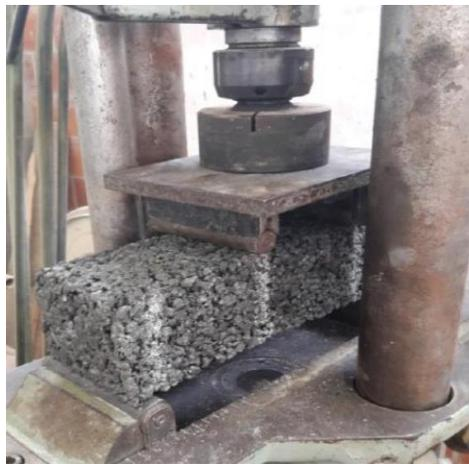
**Figura 5:** Ensaio de resistência à tração na flexão
