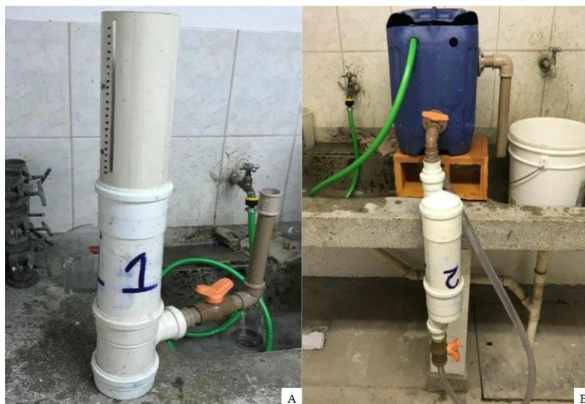
**Figura 6:** (A) Carga variável; (B) Carga constante
