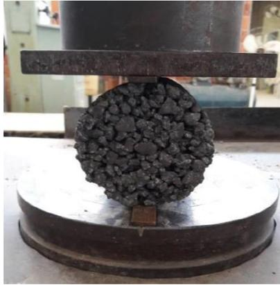
**Figura 4:** Ensaio de resistência à tração por compressão diametral
