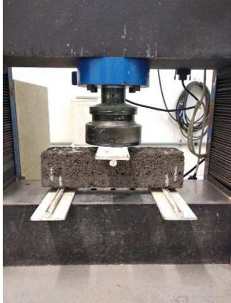
**Figura 4:** Rompimento CP por Flexão
