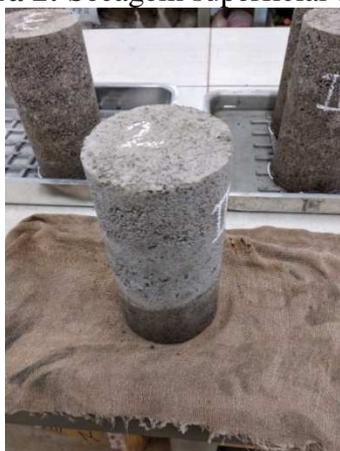
**Figura 3:** Medição da ascensão capilar
