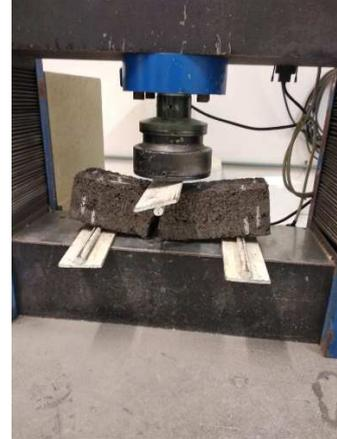
A resistência à tração por flexão foi calculada a partir da Equação 1.
