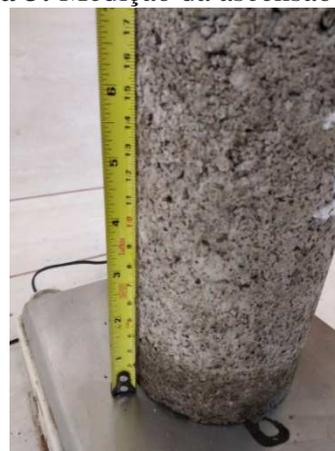
Em cada medição aferiu-se a altura da lâmina de água, e sempre que necessário foi adicionada a quantia necessária para que o nível de 5mm acima da face inferior fosse mantida.
