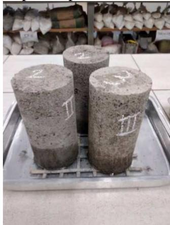
Durante o ensaio, foi determinada a massa dos corpos de prova com 3h, 6h, 24h, 48h e 72h, contadas a partir da colocação destes em contato com a água, sendo que os mesmos foram previamente secos superficialmente com pano úmido, tal qual a Figura 6, determinando o peso úmido no respectivo tempo. Além disso mediu-se a altura da ascensão capilar em centímetros em cada pesagem, como observa-se na Figura 7, sendo que após cada etapa os corpos de prova retornaram imediatamente ao recipiente de ensaio.
