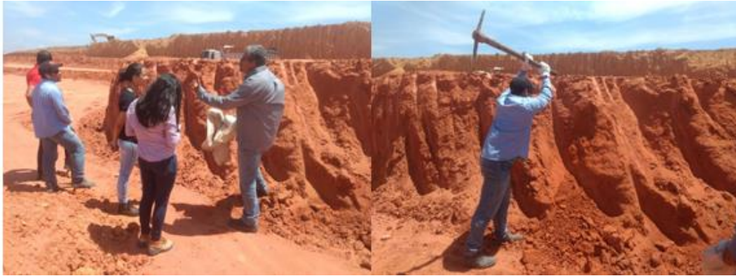
Figura 2: Coleta de amostras de solo
