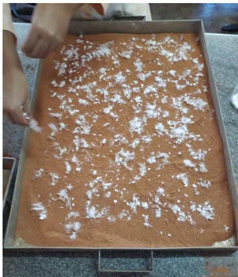
Figura 3: Procedimento de inserção da Fibra de polipropileno ao solo. Fonte: Acervo pessoal
