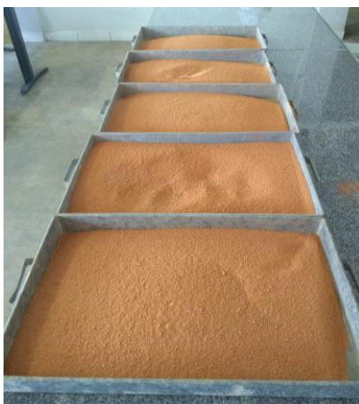
Figura 4: Separação e preparação do solo para compactação Fonte: Acervo pessoal
