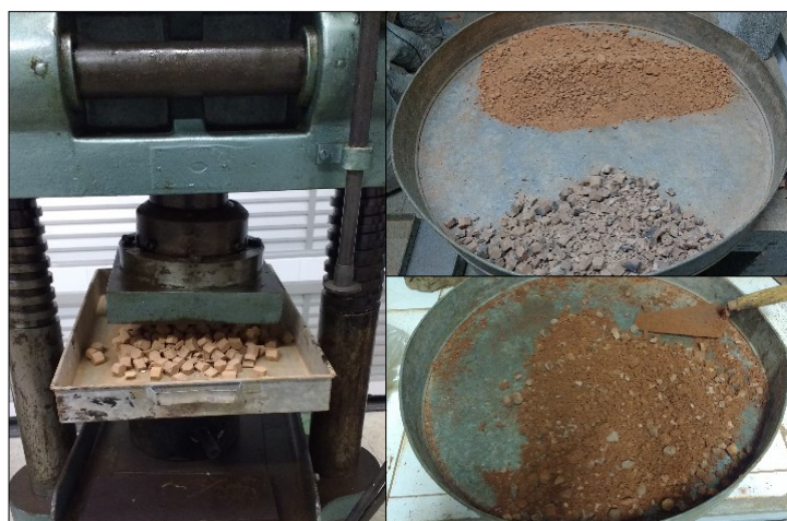
Figura 9: Britagem dos agregados produzidos e mistura com o solo laterítico.
