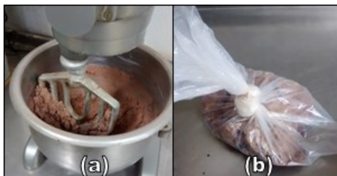
Figura 6: (a) Matéria-prima desagregada, seca ao ar e umedecida até alcançar uma plasticidade para extrusão com teor de umidade próximo à metade do Limite de liquidez; (b) vedação em saco plástico e homogeneização por 24 horas na câmara úmida.
