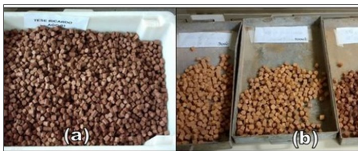
Figura 3: (a) Agregados calcinados em Nascimento (2005); (b) Barbosa (2017).
