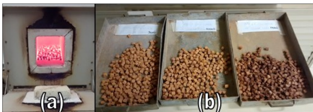
Figura 8: (a) Calcinação em forno mufla e (b) obtenção das amostras em três diferentes patamares de temperaturas – 900, 1000 e 1100 °C.
