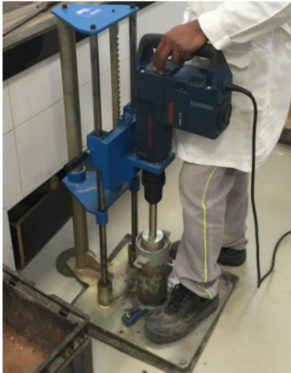
**Figura 3:** Equipamento utilizado para a compactação vibratória dos CPs
