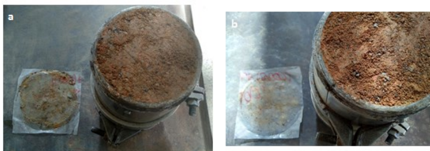
Figura 4: Características do corpo de prova da Mistura M2 na umidade de 9,5% (a); corpo de prova da Mistura M2 na umidade de 8,5% (b)
