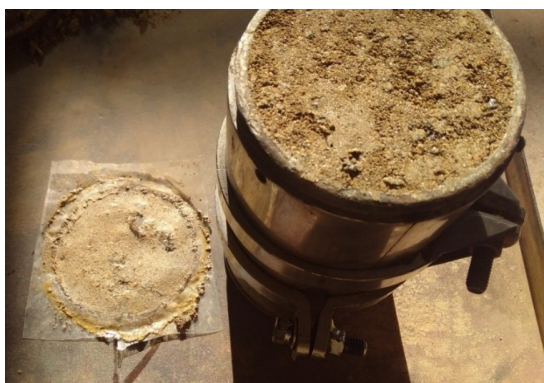
Figura 3: Características do corpo de prova da mistura M1 na umidade de 9,1%
