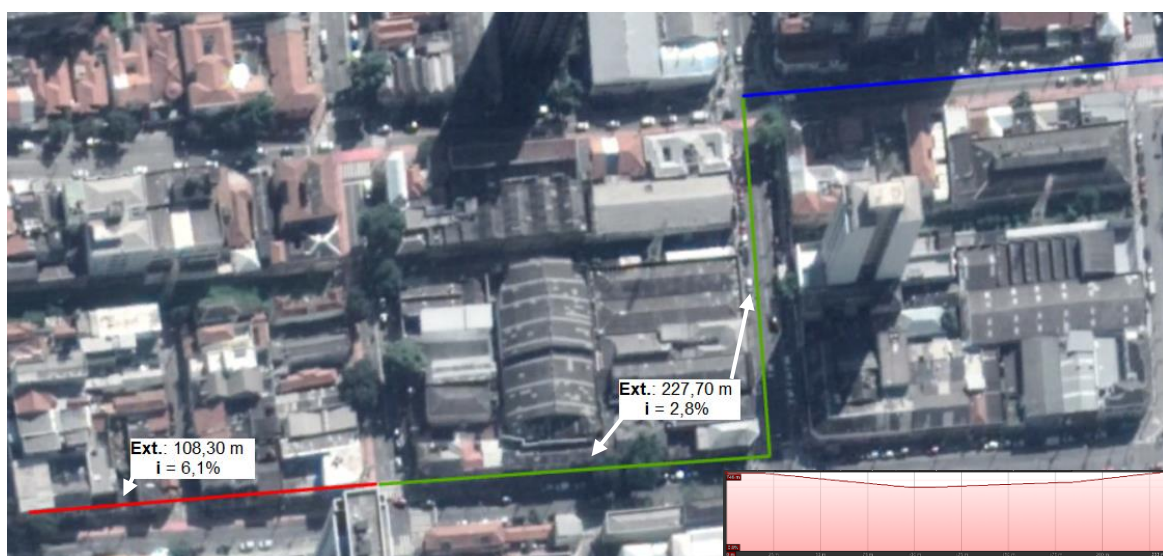
Figura 5: Proposta de alteração do percurso da ciclofaixa Do Grito, com um esboço do perfil longitudinal.
