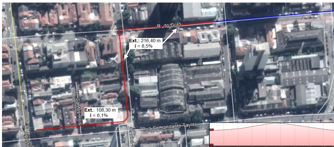
Figura 4: Trajeto original da ciclofaixa Do Grito, com destaque para o trecho crítico em vermelho e um esboço do perfil longitudinal.
