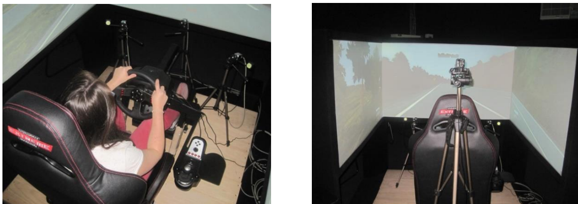
Figura 1: Cockpit e disposição do sistema de rastreamento do olhar - SmartEye (Castillo, 2015).
