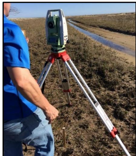
**Figura 6:** Estação total instalada sobre um ponto auxiliar, às margens da via
