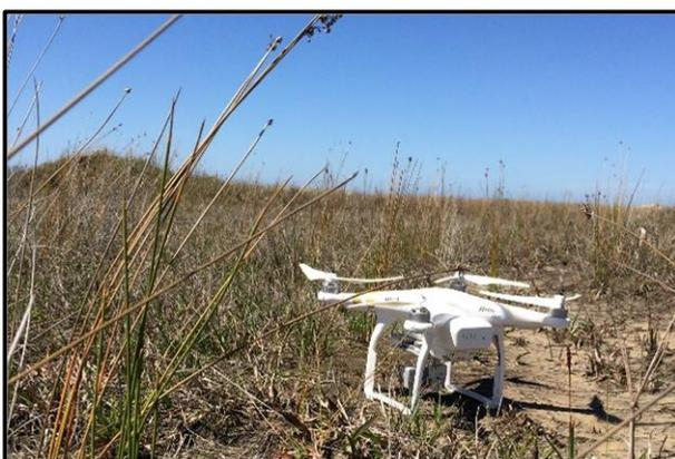
**Figura 3:** *Drone* *Dji Phantom 3* utilizado para o levantamento aerofotogramétrico.
