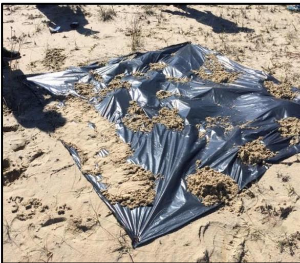
**Figura 5:** Superfície utilizada como alvo e ponto de apoio ao levantamento
