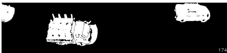
**Figura 3:** Imagem binária após subtração de fundo
