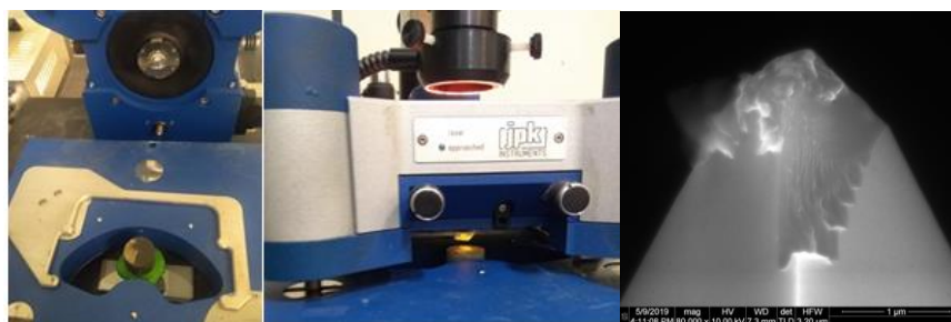
Figura 6: Amostras de LD e ACBFS posicionadas no AFM e ponta-ligante vista ao MEV
