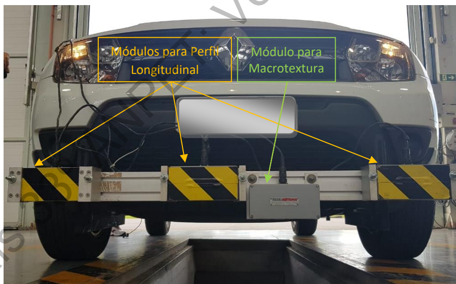
Figura 1: Perfilômetro a laser utilizado no monitoramento.
