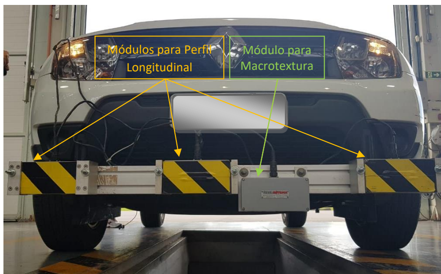
Figura 1: Perfilômetro a laser utilizado no monitoramento.
