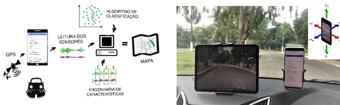
Figura 1: Esquema do processo de criação do mapa e registro da captura dos dados
