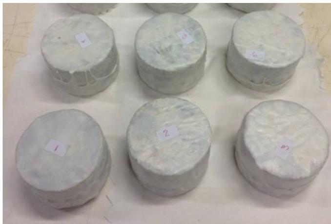
**Figura 1:** Aparência dos corpos de prova envoltos na parafina
