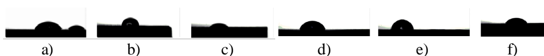
Figura 7: Gotas sobre ACBFS polida usando a) água, b) glicerol e c) diiodometano e gotas
