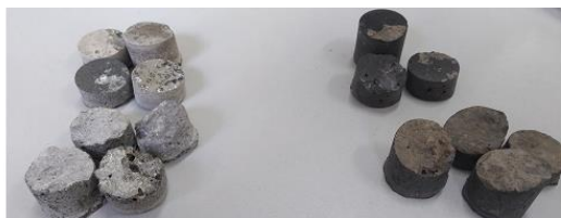
Figura 1: Amostras cilíndricas de ACBFS e LD extraídas para realização dos ensaios de SFE e AFM
