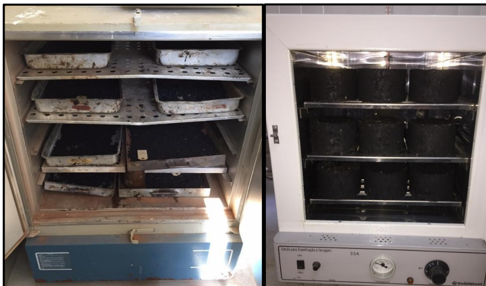
Figura 2: a) Envelhecimento de mistura solta em estufa, b) Envelhecimento de corpos de prova compactados.
