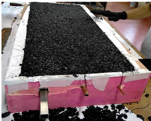
Figura 2: Molde preparado com as canalizações e a massa asfáltica
