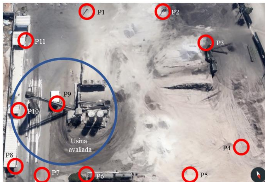
Figura 6: Distribuição dos amostradores passivos no local da usina avaliada (Fonte: Google Earth).
