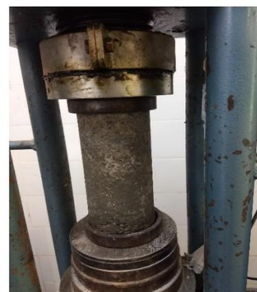
a) Resistência à compressão - cilindros
