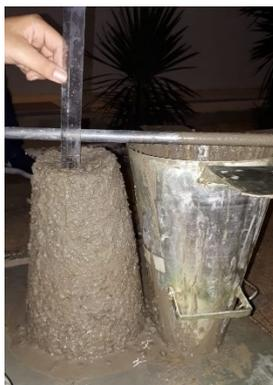
Figura 6: Slump test do T25
