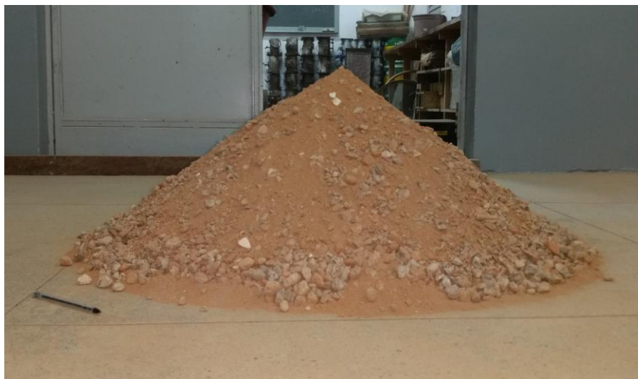
Figura 1: Mistura de solo com RCC.
