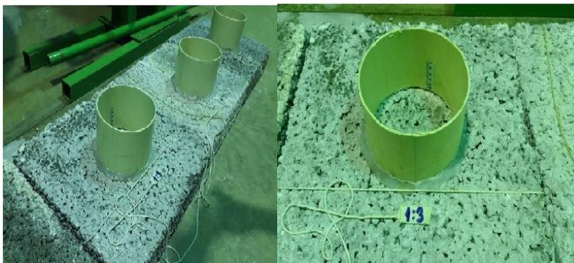
**Figura 4:** Preparação da placa para ensaio de permeabilidade.
