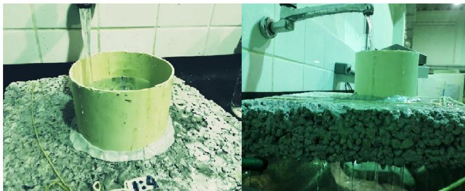
**Figura 4:** Realização do ensaio de permeabilidade.
