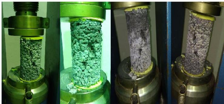
**Figura 6:** Linha de ruptura dos corpos de prova.
