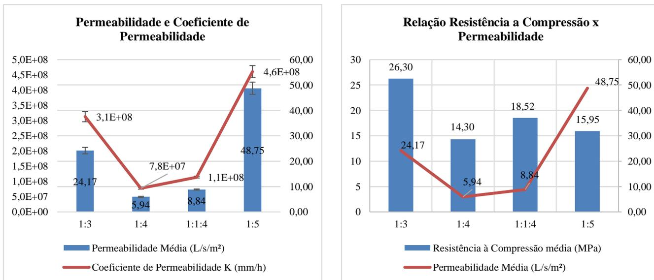
(a) Gráfico – Permeabilidade e Coeficiente de Permeabilidade
