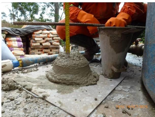
**Figura 6:** Abatimento do tronco de conde do concreto sem fibras
