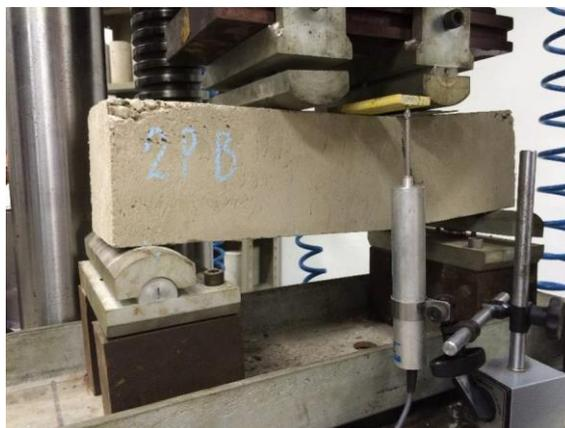
**Figura 3:** Disposição do ensaio de flexão.
