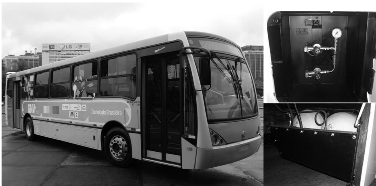
Figura 2: Adaptação do veículo para o sistema dual-fuel diesel gás
