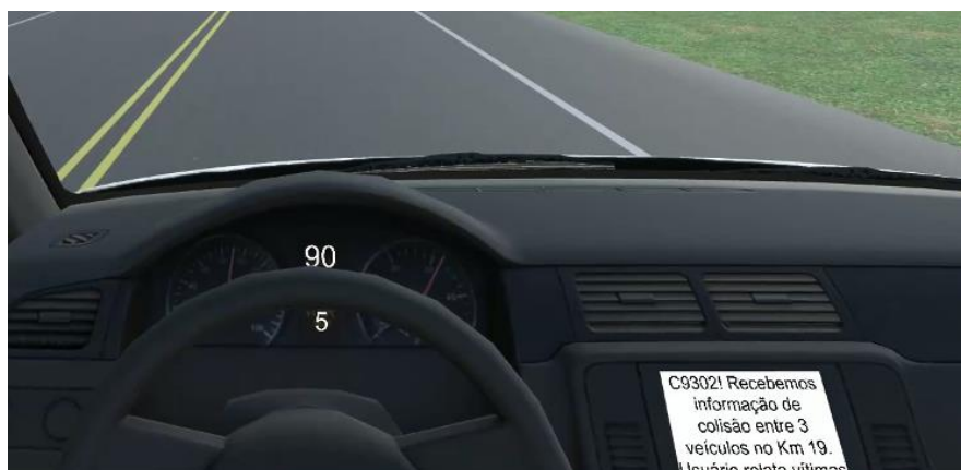
Figura 2: Painel do veículo de simulação, no canto inferior direito pode-se ver a tela por onde as mensagens eram transmitidas.
