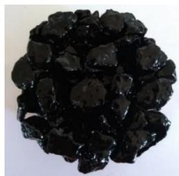
**Figura 2:** Aspecto visual da adesividade ligante-agregado após condicionamento
