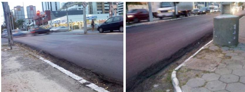
**Figura 1:** Projeto geométrico comprometido com revestimento em cotas superiores às das calçadas (Fonte: Jornal O Povo, 2010)
