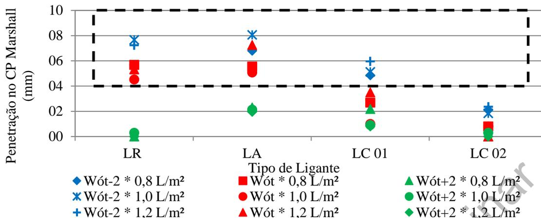
Figura 3: Penetração dos ligantes no cilindro Marshall
