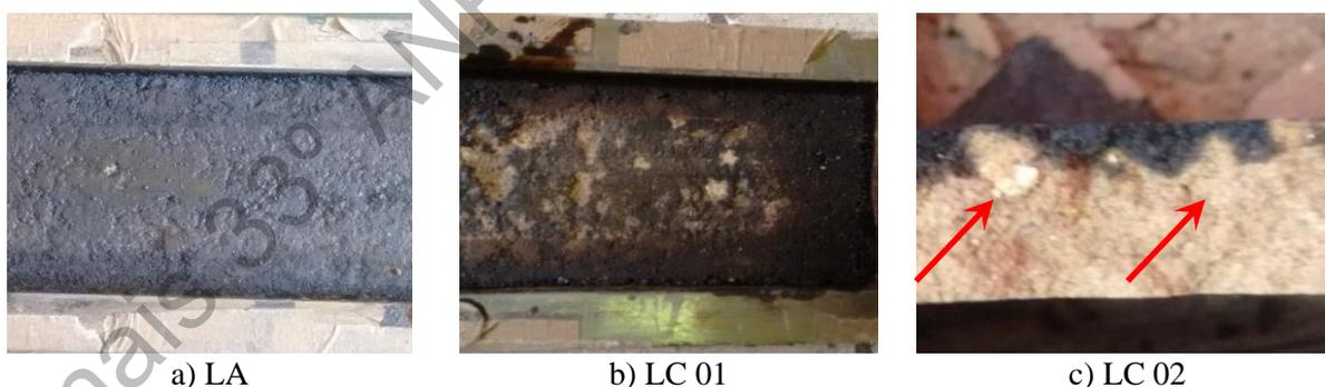
**Figura 6:** Aspecto das placas após o ensaio LWT à taxa de  $0,8 \text{ L/m}^2$  na  $W_{ót-2}$
