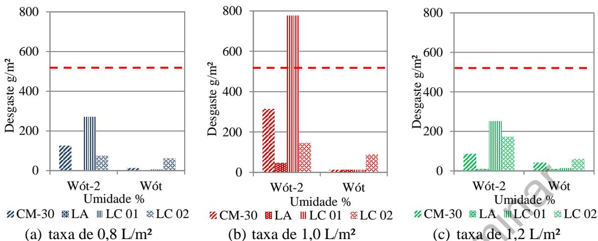
**Figura 4:** Desgaste superficial nas taxas 0,8, 1,0 e 1,2 L/m<sup>2</sup> nas umidades Wót-2 e Wót
