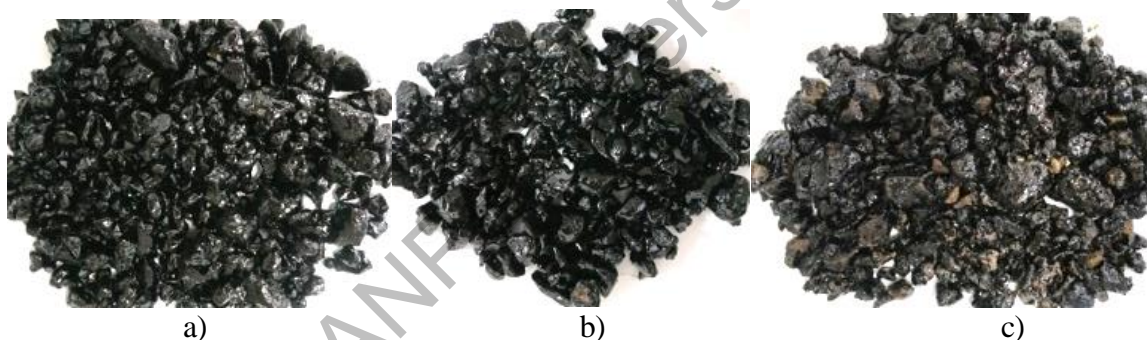
Figura 13: Resultado Boiling Test : a) LD igual em volume; b) LD igual em massa e c) ACBFS.
