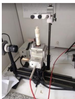
Figura 4: Esquema do ensaio SFE com o ligante asfáltico
