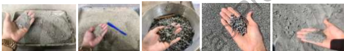
Figura 1: Escória de aciaria LD, Escória granulada de alto forno, Brita 0 fina, Granilha e Pó de brita
