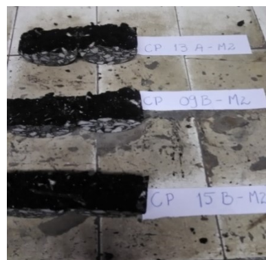
(c) Corpos de prova rompidos
