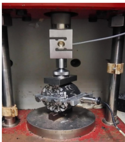
Figura 2: Ensaio para a determinação do MR
