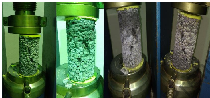
Figura 6: Linha de ruptura dos corpos de prova.
