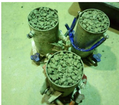
Figura 3: Corpo de prova nos moldes.
