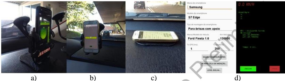
**Figura 2:** Tipos de suportes utilizados: a) para-brisas com apoio, b) para-brisas sem apoio e c) painel; e d) interface do aplicativo desenvolvido para a coleta dos dados.
