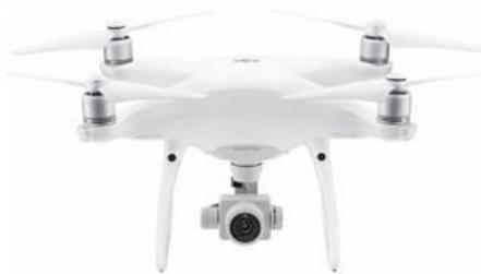
**Figura 3:** RPA quadricóptero Phantom 4 Pro
