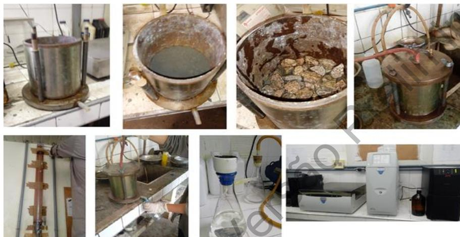
**Figura 1:** Ensaio de lixiviação em amostra compactada
