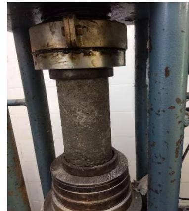
a) Resistência à compressão - cilindros
