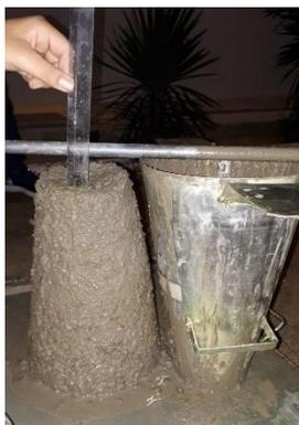
Figura 6: Slump test do T25
